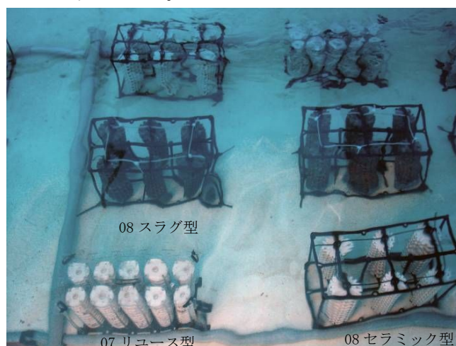
図Ⅱ.6.7 着床具の設置状況
