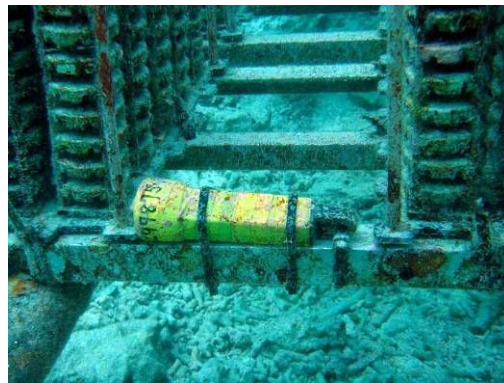
図Ⅱ.5.11 架台に取り付けた自記式水温計 (生物の付着防止のためビニールテープを巻いてある)
