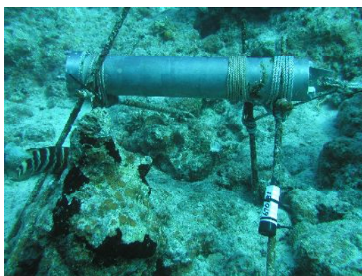
図Ⅱ. 11. 17 濁度計設置状況（右下は自記式水温計）
