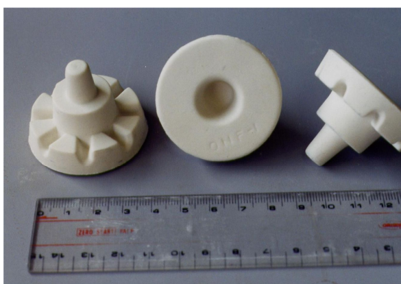
図 4-17 開発された着床具 (岡本・野島 2003)
